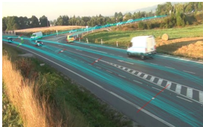
Obr. 9. Inovatívny zber dopravných údajov v mieste križovatky ciest
