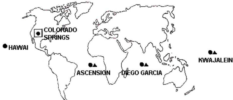
Obr. 2.1. Rozmiestnenie staníc riadiaceho segmentu GPS: □ hlavná riadiaca stanica, ● monitorovacie stanice, ▲ pozemné komunikačné stanice.
