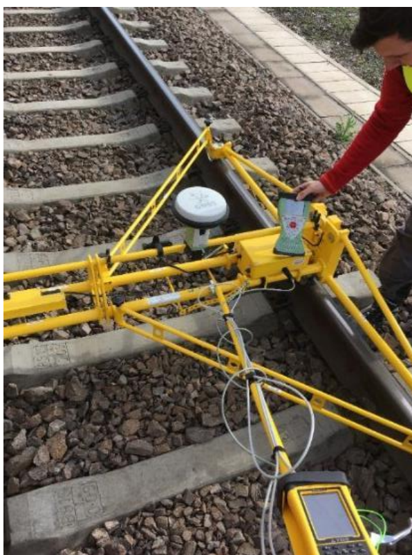
Obr. 11. Meranie geometrickej polohy koľaje
