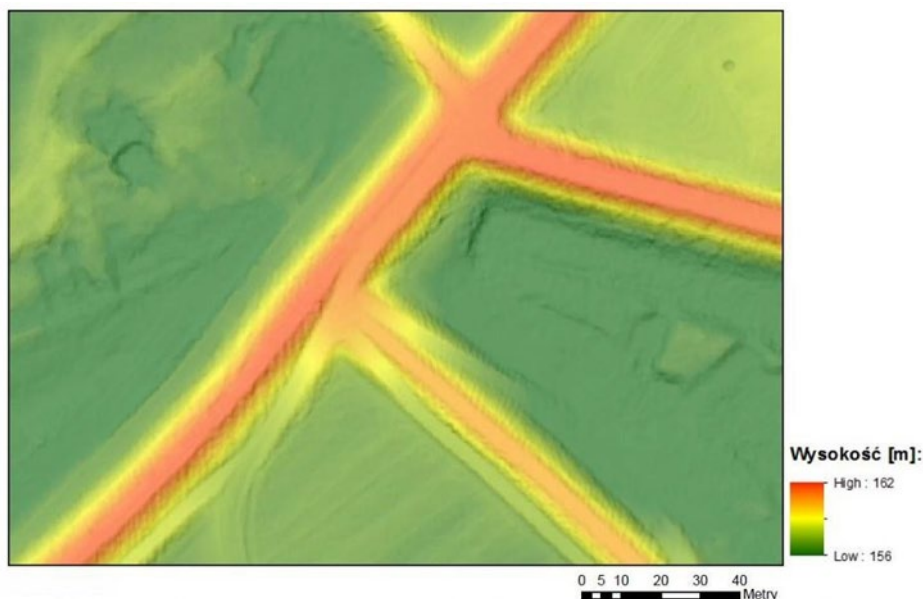
Obrázok 14: Príklad snímky získanej superponovaním tieňovaného modelu a hypsometrických farieb - získala sa podrobná topografia hrádze (Kurczyński Z., Bakula K., 2016).
