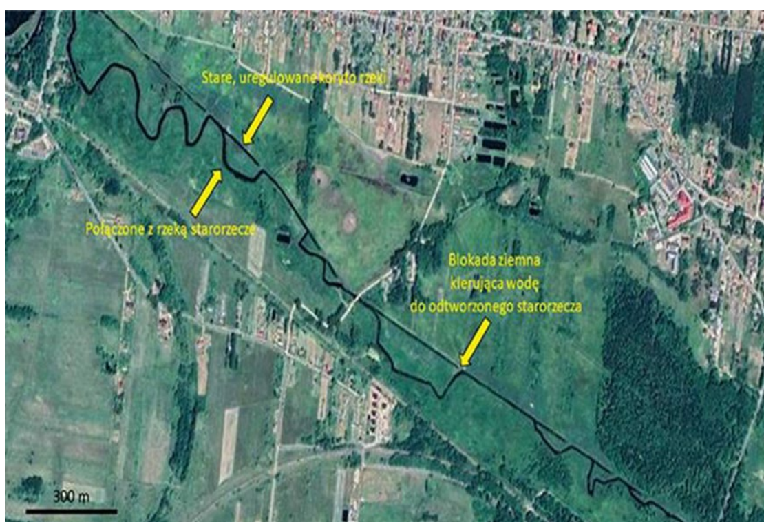
Obrázok 4: Obnova bývalého meandrujúceho toku rieky Narewka v Białowieži prehradením toku v regulovanom koryte a odvedením vody do obnovených mlák ( https://inzynierbudownictwa.pl/renaturyzacja-rzek/ ).
