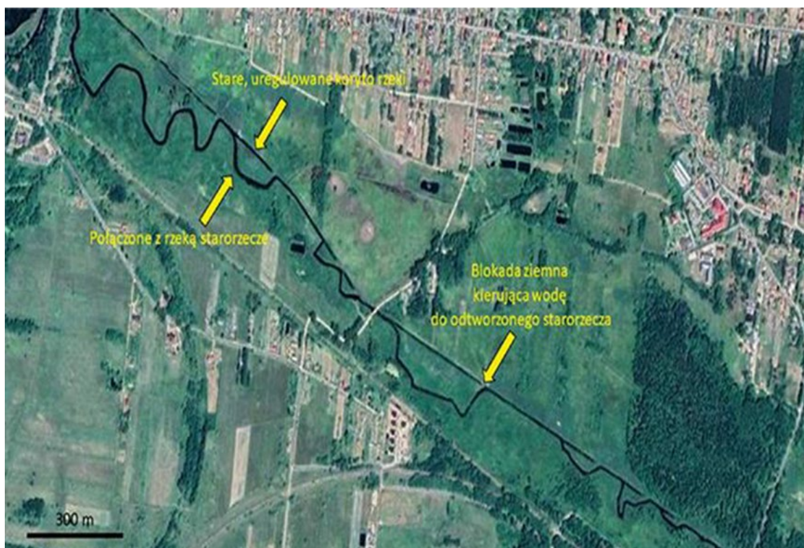
Obrázok 9: Obnova bývalého meandrujúceho toku rieky Narewka v Białowieži prehradením toku v regulovanom koryte a odvedením vody do obnovených mlák
