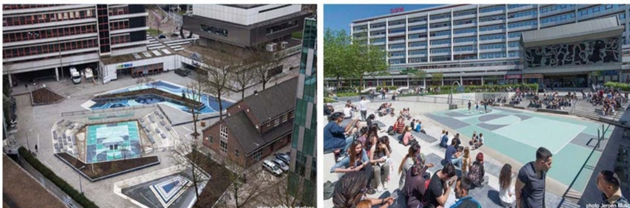
Obrázok 14: Námestie Bentheplein v Rotterdame (Holandsko). Postavený v roku 2013 je príkladom suchej protipovodňovej nádrže v obytnej štvrti. Počas nadmerných zrážok môže zadržať približne 2 milióny litrov vody, ktorá steká z okolitých oblastí. Počas dní bez dažďa nádrž funguje ako verejný otvorený priestor, ktorý ochotne využívajú miestni obyvatelia (Suchocka a Siedlecka, 2017).
